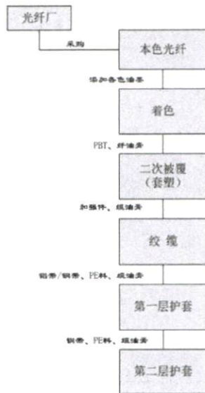
图 8-3 GYTA53 工艺流程图
